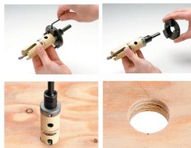
矢印下部のネジ穴にレンチを差込み、ネジを緩めてザグリカッター60を外します。
