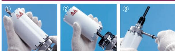
① アダプターのダイヤルを反時計方向に廻してゆるめます。
